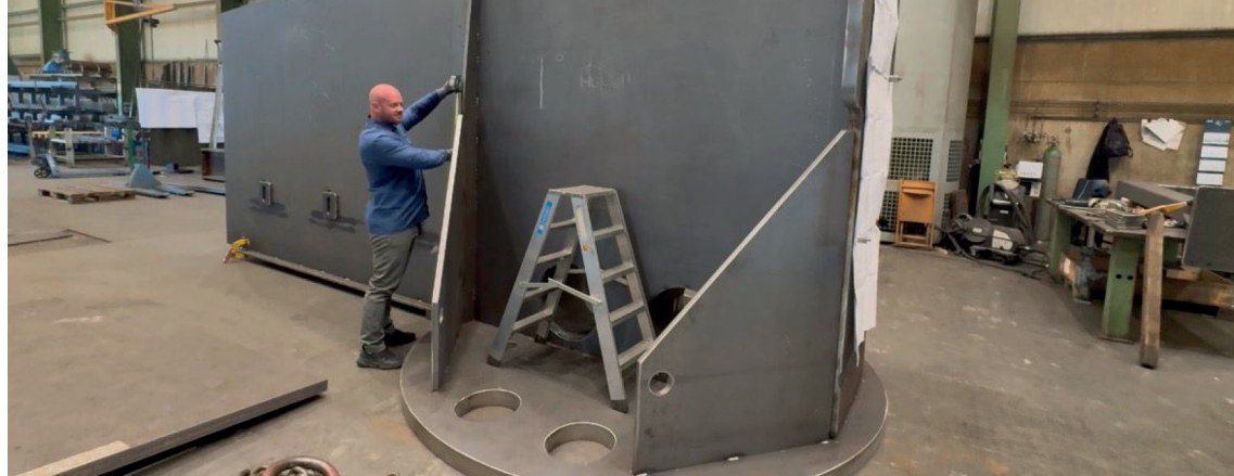
Ein erster Blick auf unseren neuen Kran: Hier ist ein Teil des Auslegers zu sehen. Der Stahlbau bei Vetter Krantechnik schreitet sichtbar voran.
